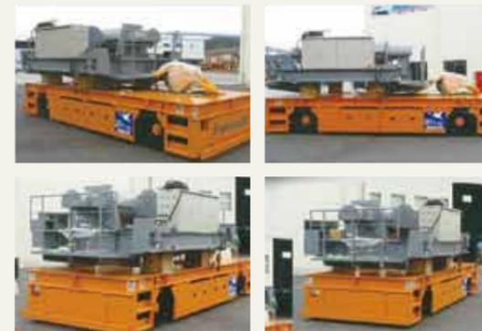
コンパクトボディで大パワーの無限軌道台車。大型車両では侵入できない狭い空間でも重量物の搬送が可能です。運転は無線操縦装置により、長尺物の搬送も、一人作業で、離れた位置から全体の安全を確認しながら行えます。走行電動機はインバータ制御で低速・高速の2速運転、状況に合わせて安全でスムーズな作業ができます。
